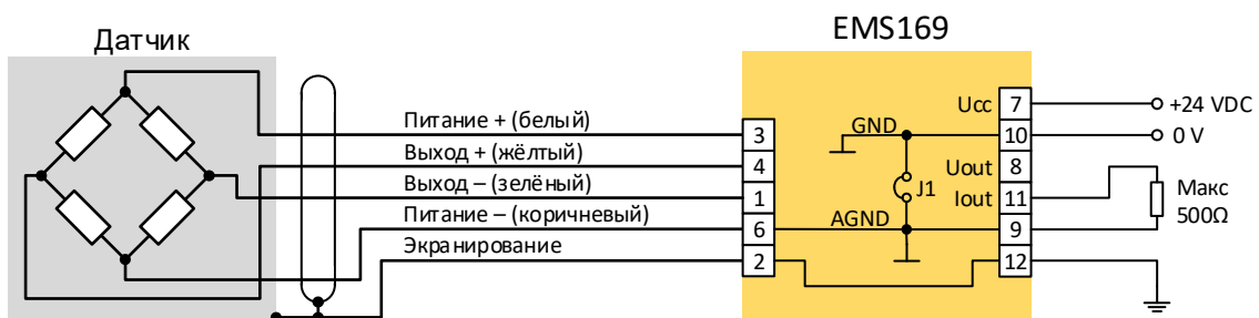
Рис. 4. Присоединение преобразователя с выходом по току.
