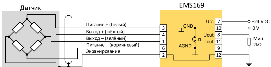
Рис. 3. Присоединение преобразователя с выходом по напряжению
