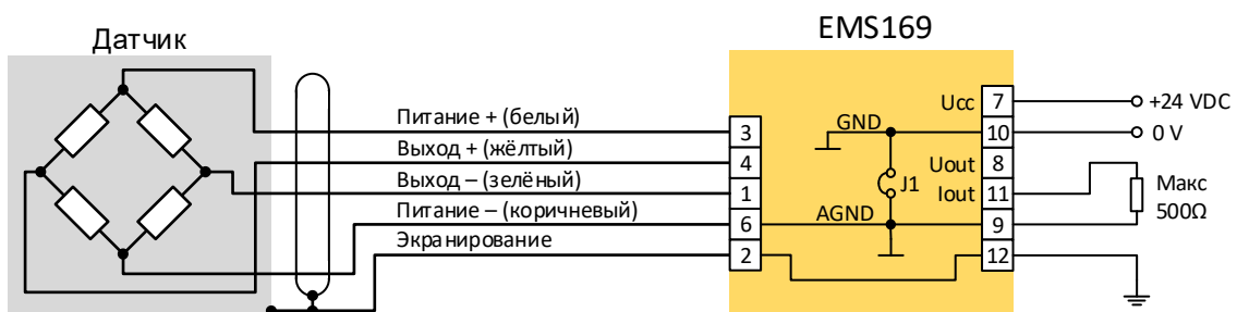
Рис. 4. Присоединение преобразователя с выходом по току.
