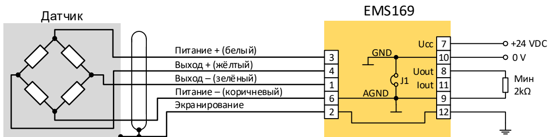
Рис. 3. Присоединение преобразователя с выходом по напряжению
